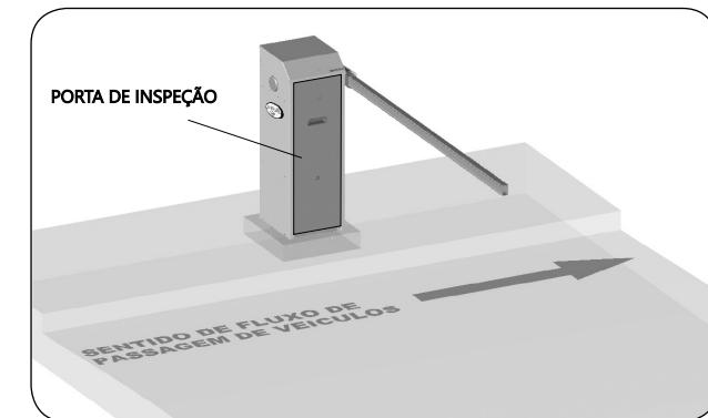
2. Posicionar / alinhar o gabinete sobre a base e fazer a marcação dos furos, de modo que a frente da cancela (lado da porta de inspeção) esteja localizado em direção ao meio fio (rua, passagem de veículos)
