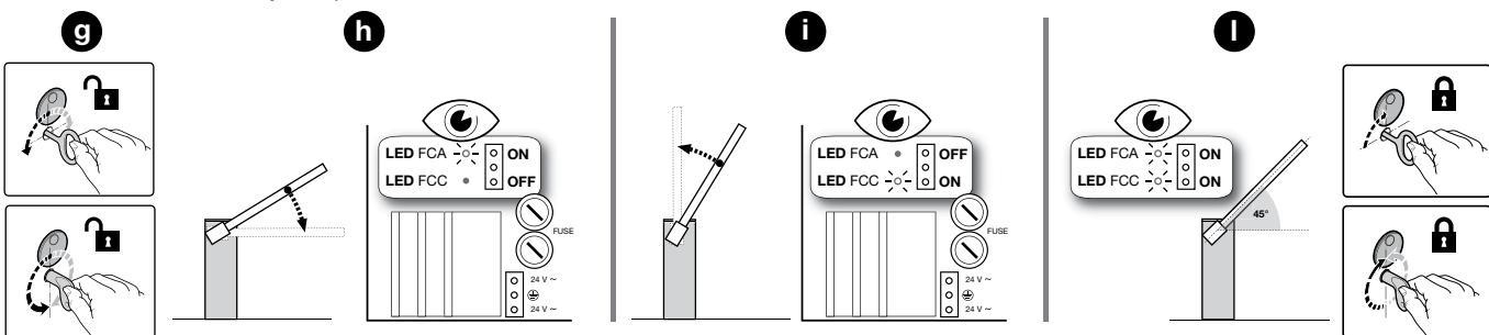
**Nota - para aprovechar la función de ralentización, es necesario que el tope se active aproximadamente 20° antes del punto de bloqueo mecánico; si fuera necesario, regular las dos levas para seleccionar el punto deseado**
