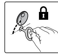
**04.** Utilizando el selector de llave o la tecla de mando realizar pruebas de cierre, apertura y parada del elevador de barrera y comprobar que el movimiento sea correcto: se recomienda hacer varias pruebas para evaluar el movimiento de la barrera y comprobar los posibles defectos de montaje, o de regulación, así como la presencia de puntos de fricción
