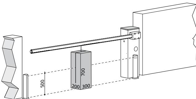
En caso de prueba de dos pares de fotocélulas, la prueba se debe ejecutar primero individualmente para cada par de fotocélulas utilizando 1 cuerpo de prueba y luego se debe repetir utilizando 2 cuerpos de prueba.
